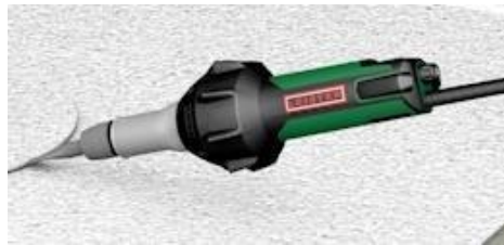
Sử dụng máy hàn tay Leister Triac AT để hàn khóa đầu mối nối
